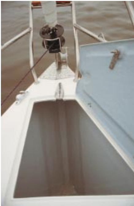
Der Ankerkasten bietet Platz für eine Winsch, Anker und Kette und ist ein bißchen zu groß geraten.
