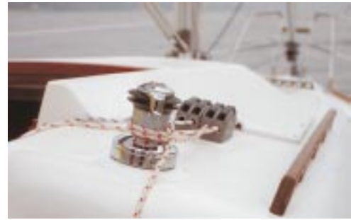
Die Fallen werden vom Mast aus in den Rollenkasten umgelenkt und laufen dann verdeckt weiter bis zu den Hebelklemmen.
